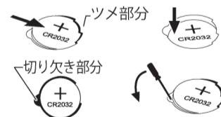
補助電池の外し方 補助電池を外すときは、切り欠き部分にドライバー等の先の細いモノを差し込んで引き上げて下さい。
